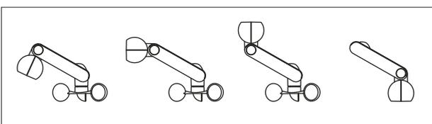
**Maximale Flexibilität:** mit einer einstellbaren Halterung zur Befestigung auf Oberflächen mit jeder Neigung.
