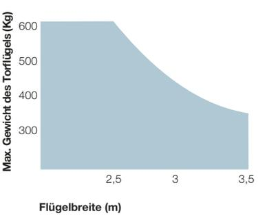
Form und Höhe des Tors sowie starker Wind können die Werte in der graphischen Darstellung bedeutend reduzieren. In windigen Gebieten empfehlen wir vorzugsweise die 230 Vac Modelle zu benutzen.
